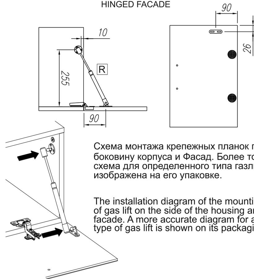
Схема монтажа крепежных планок газлифта боковину корпуса и Фасад. Более точная схема для определенного типа газлифта изображена на его упаковке.
